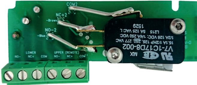
Cuando instale la tarjeta de conmutación, asegúrese de que está colocada correctamente. Fije la tarjeta de circuito impreso con los dos tornillos. Asegúrese de que los orificios estén centrados antes de apretar los tornillos.
